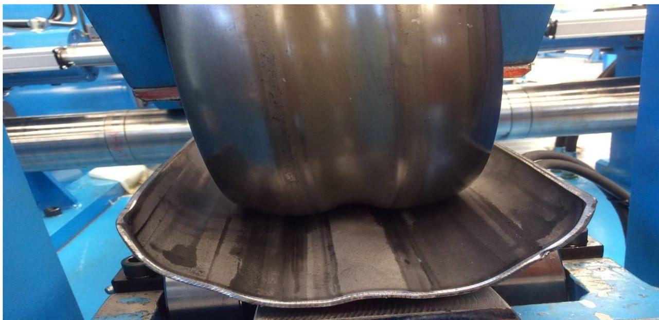
OMM offre soluzioni innovative, speciali e flessibili con la sua nuova linea di profilatura dei pali di illuminazione con un alto tasso di produzione e un modo molto innovativo di produrre gusci che rendono molto conveniente e adatta questa macchina per impianti di produzione di pali con elevata produttività.
